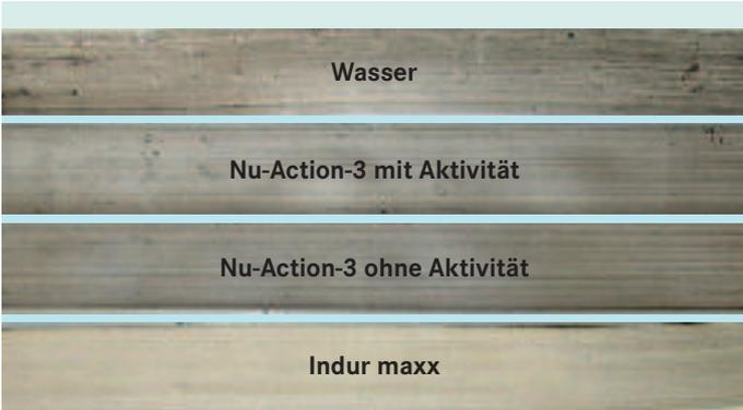
In Abhängigkeit von den Reinigungsfähigkeiten der getesteten Produkte waren die PVC-Beläge anschließend mehr oder weniger stark aufgehellt.
